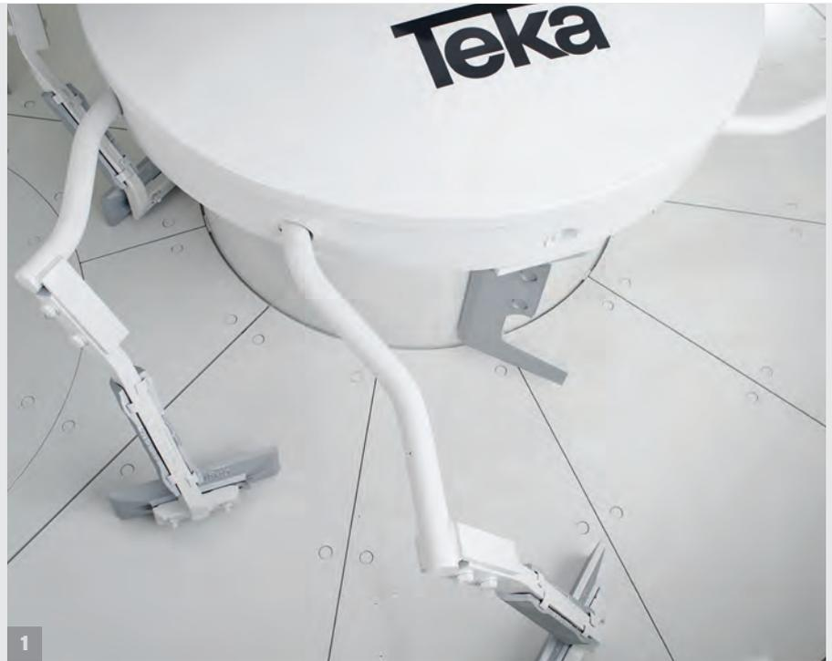
**2** | Eine Zentralschmierung der Mischarm-Buchsen gibt es als Sonderausführung. Mischschaufeln, Schleifmanschetten zum Schutz der Mischarme und Wandabstreifer
